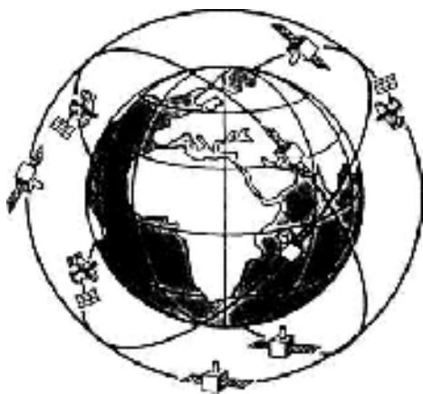
Рис. 2.4. Вариант космической системы, включающей группировку из девяти малых спутников, функционирующих на трех орбитах с разным наклонением.
